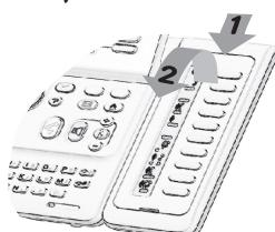
El teléfono puede estar equipado con una caja de extensión. Así dispondrá de teclas adicionales configurables como teclas de función, teclas de línea, teclas de llamada, etc. **Para colocar las etiquetas:** tire hacia usted de la lengüeta de soporte de la cubierta de las teclas y levante esta última. Sitúe la etiqueta bajo el bloque de teclas, en el lugar previsto a tal efecto y vuelva a colocar en su sitio la cubierta.
