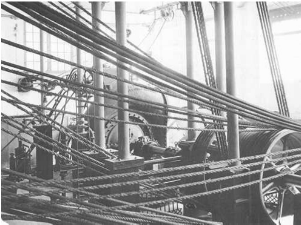
Turbina Planas de Can Sedó (Esparraguera). Era la més potent de l'època i proporcionava 1.200 CV. Font: Museu de la Colònia Sedó del Museu Nacional de la Ciència i de la Tècnica de Catalunya
