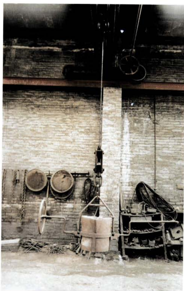
Nau número 1. Gresol gran per transportar el ferro fos. Aquest eliminava els gresols portats a mà per dos obrers i els gresols de carretó. Aquest gresol gran el movia una grua al llarg de tota la nau. Any 1995. (Fotografia: Oriol Saula. AFMCUT)
