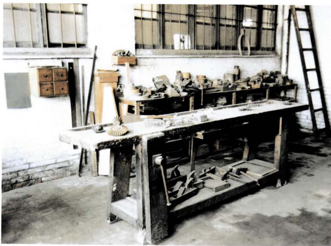
Nau número 4. Detall de l'oficina tècnica de modelatge. Destaca el banc de treball del modelista. Any 1995. (Fotografia: Oriol Saula. AFMCUT)
