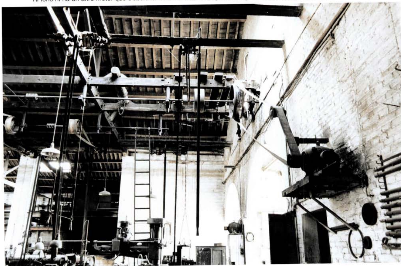
Nau número 5. Detall de l'embarrat accionat per un sol motor. Al fons hi ha un altre motor que s'acciona en cas d'avaria del primer. Any 1995. (Fotografia: Oriol Saula. AFMCUT)
