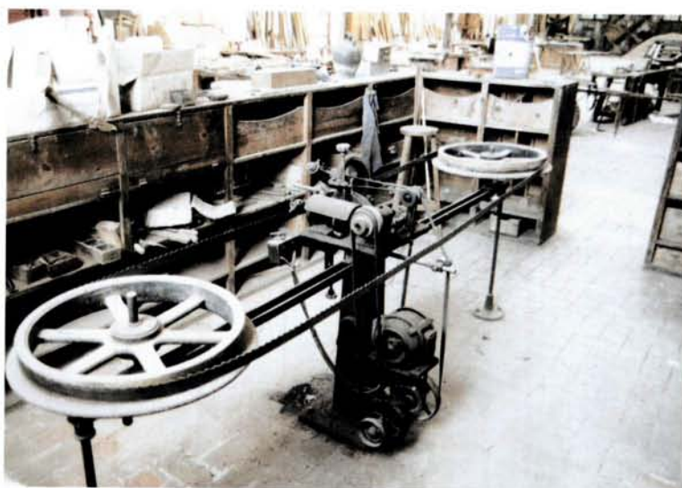
Nau número 17. Zona de l'encarregat de la fusteria. En primer terme, la màquina afiladora de les serres de cinta. Any 1995.
